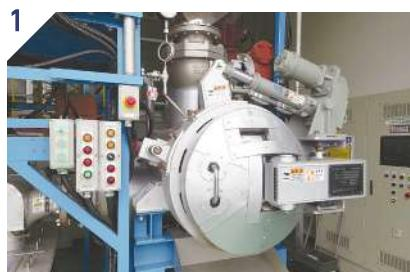
水熱反応装置
